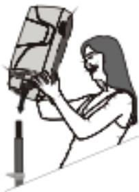
**1.** Inserte un pin de TV en el extremo superior del soporte y asegúrelo con la manija ubicada al costado. Pin para TV: pin TV-35 para altavoces (código 60000735).
